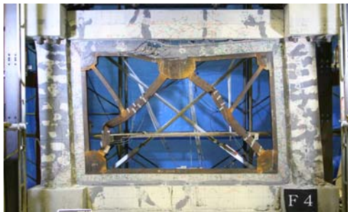
写真-2 最終破壊状況(補修後再載荷)
