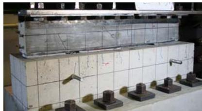
(b) アンカー筋間隔 300mm (H31)
