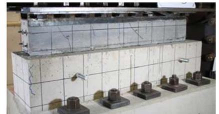
(c) アンカー筋間隔 600mm (H61)
