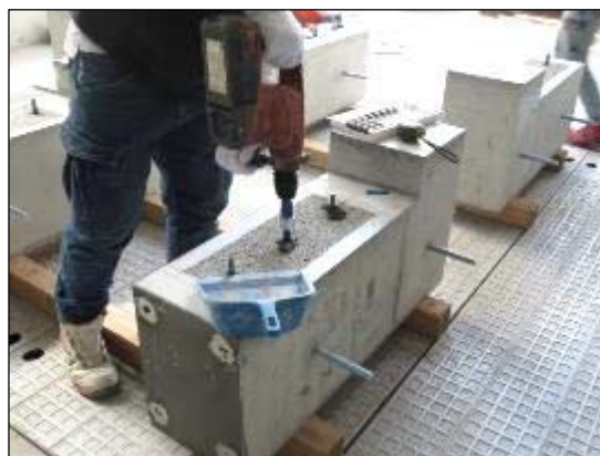
(b) ②あと施工アンカー打設
